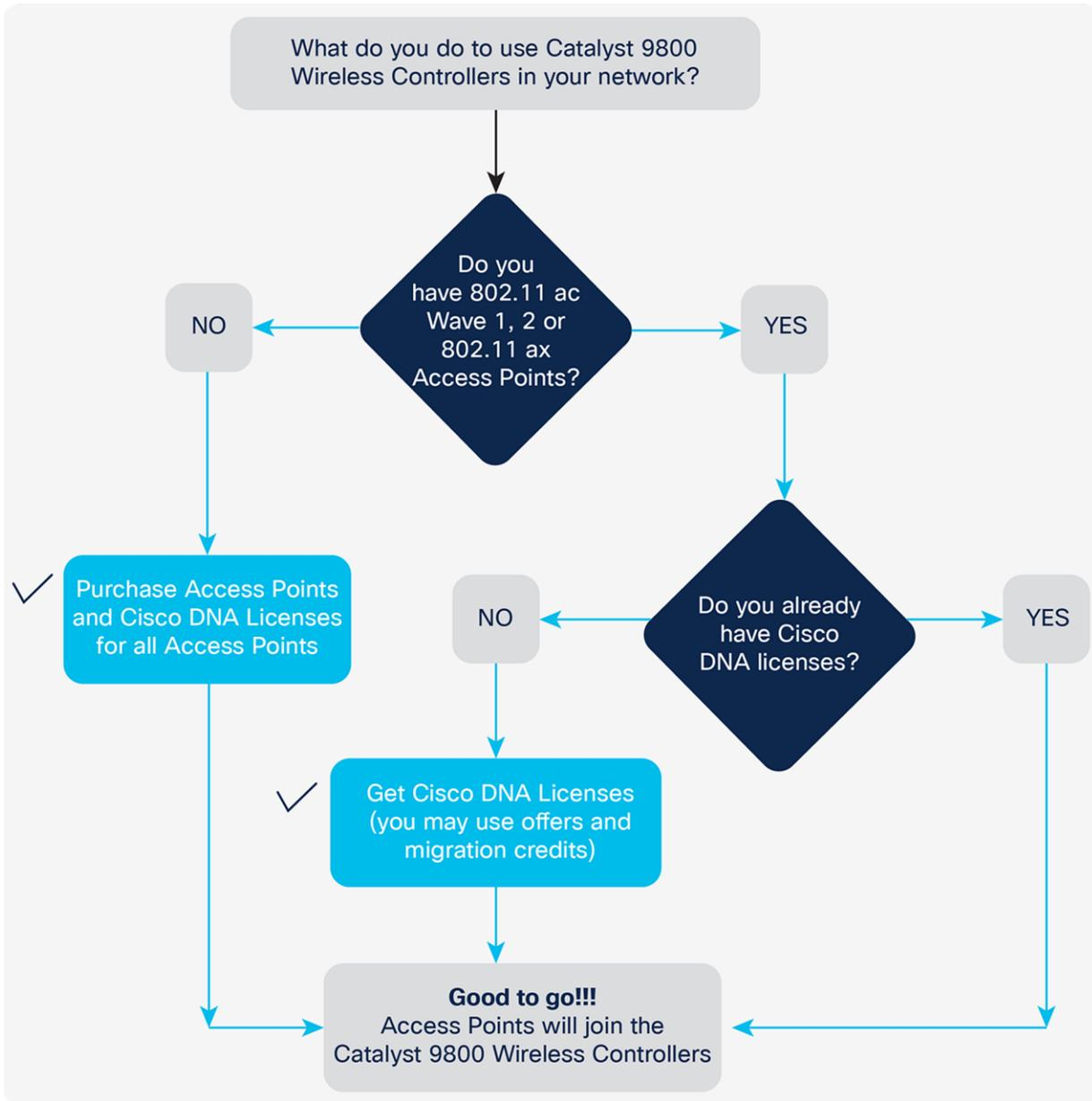
Los puntos de acceso que se conectan a un controlador Cisco Catalyst de la serie 9800 tienen paquetes de suscripción de software nuevos y simplificados.
